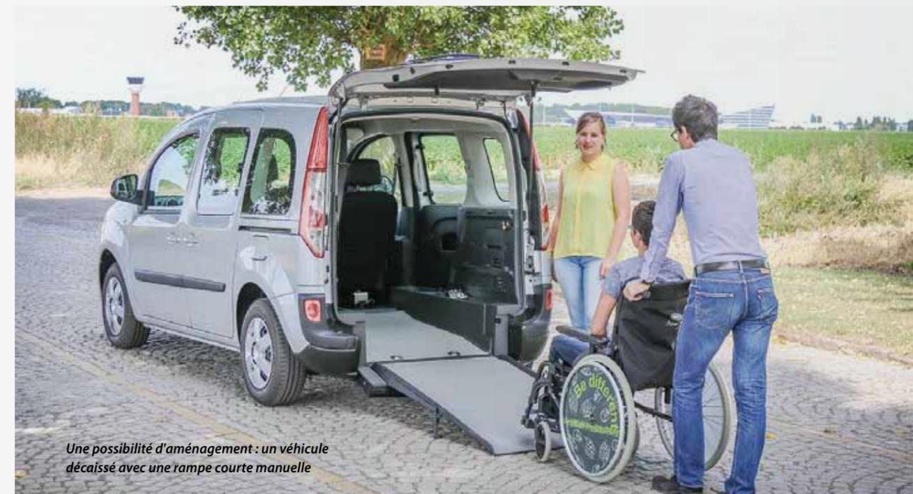
Une possibilité d'aménagement : un véhicule décaissé avec une rampe courte manuelle
